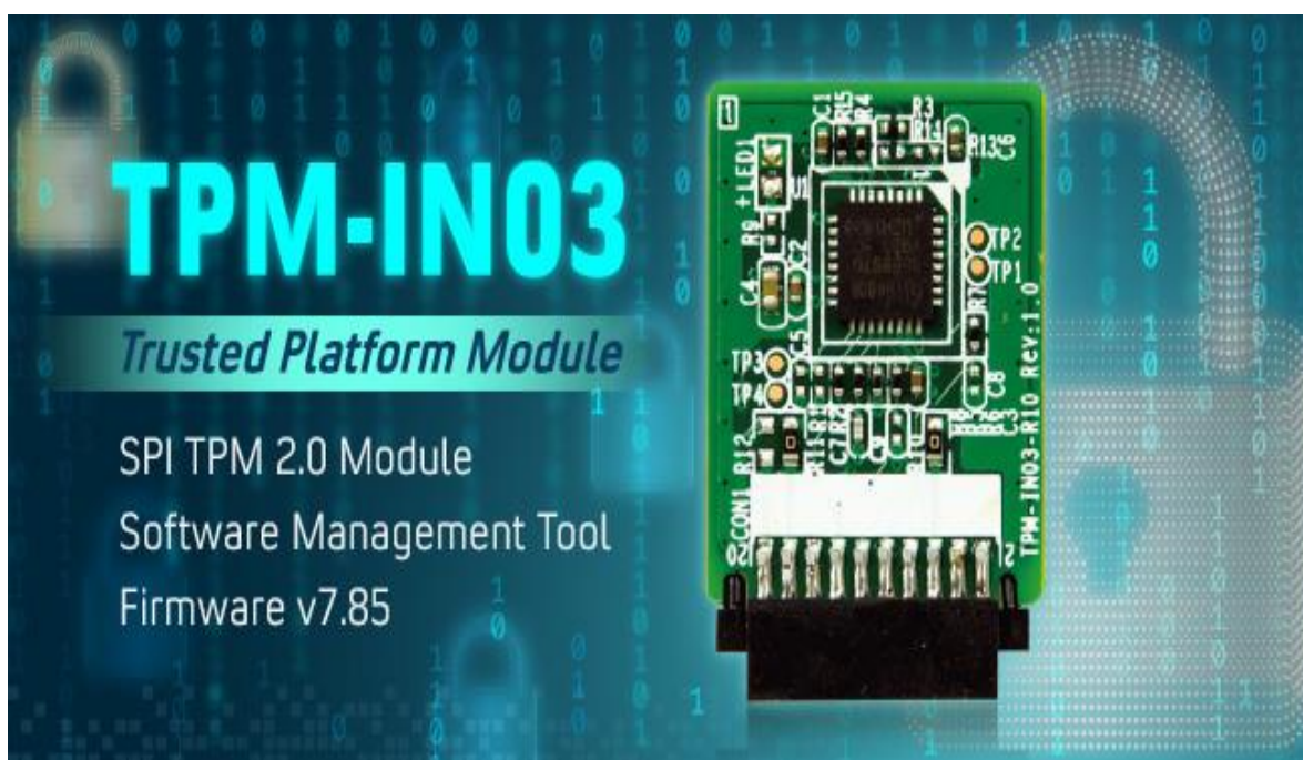
【▲ Trusted Platform Module (Discrete TPM) (参考： https://www.ieiworld.com )】
