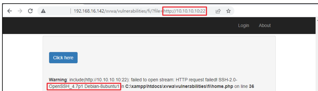
【▲図⑭ 内部サーバ22番ポートにアクセス時、SSH情報漏出】
